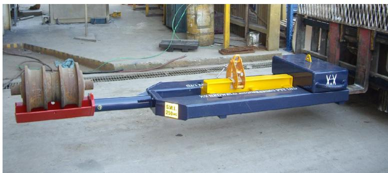
Herramienta de retiro del rodillo del dozer en uso con la grúa horquilla
